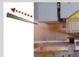
Spanflug Z3 Chipmeister: gerichteter Spänestrahls zur Absaugung
